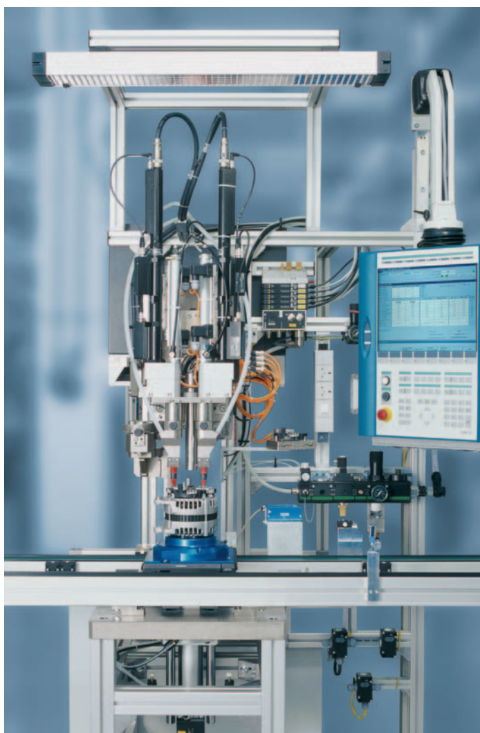
▲ Stazione di avvitamento per la produzione di generatori Estación de atornillado para la producción de generadores Estação de parafusamento para a produção de geradores Robert Bosch GmbH, Stuttgart, D
