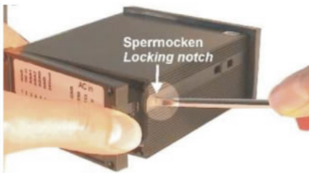
Entfernen der Rückwand
