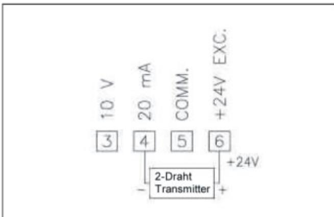
Bild 7.6: Anschlußbeispiel 4: 2-Draht 20 mA Stromschleife
