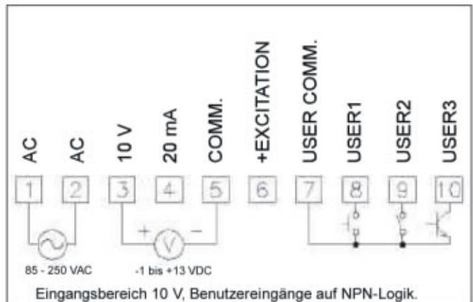
Bild 7.3: Anschlußbeispiel 1: Spannungssignal
