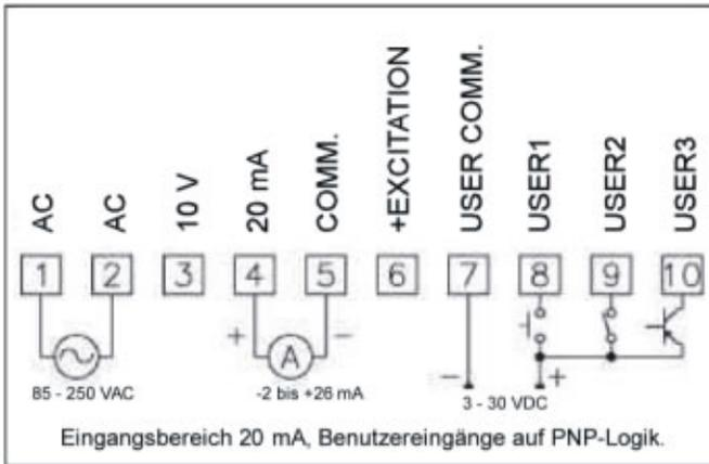
Bild 7.4: Anschlußbeispiel 2: Stromsignal
